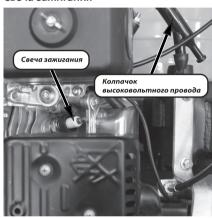
Снимите колпачок высоковольтного провода. Для извлечения свечи из двигателя пользуйтесь свечным ключом из комплекта. Проверяйте состояние свечи зажигания каждые 25 моточасов работы. Регулярно чистите свечу зажигания и проверяйте зазор между электродами. Зазор должен быть 0,6-0,7 мм. После проверки или замены закрутите свечу до упора свечным ключом.
