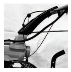
При установке рукоятки управления следить за тем, чтобы тросики и электропроводка не перекручивались и не были в натянутом положении.
