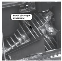
Двигатель необходимо очищать от грязи каждый раз после окончания работы с мотоблоком. Грязный двигатель и загрязненные ребра цилиндра двигателя могут стать причиной его перегрева и поломки.
