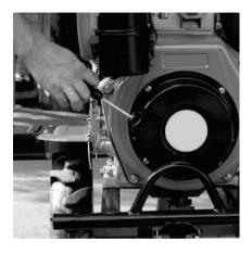
Вытяните запускной шнур стартера до момента,пока не появится сопротивление. Произведите запуск двигателя, вытянув запускной шнур стартера на ¾ его длины,если двигатель не заводится, повторите операцию.
