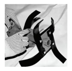
**ШАГ 17.**Собрать почвенную фрезу, прикрутив режущие ножи при помощи крепежа.
