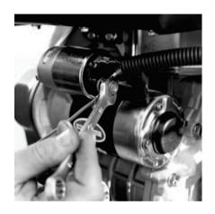
**ШАГ 25.**Подсоединить второй конец «+» провода к клемме электростартера.
