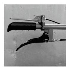
Нажмите рычаг **«Вкл/Выкл»** двигателя и зафиксируйте его.
