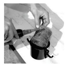
Перед установкой воздушного фильтра заправить его маслом, предварительно пропитав фильтрующий элемент.
