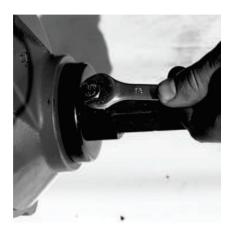
**ШАГ 3.** Закрепить пыльник фиксатором.
