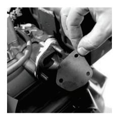
Убрать защитную прокладку впускного коллектора воздушного фильтра.
