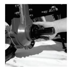
**ШАГ 2.** Установить пыльник на входной вал редуктора.
