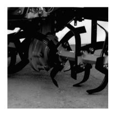
**ШАГ 19.**Соединить почвенные фрезы с выходным валом редуктора.
