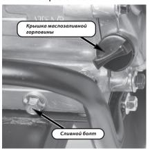
Открутите болт сливного отверстия и крышку маслозаливной горловины. Слейте отработанное масло. Производите замену моторного масла первый раз после 5 моточасов работы. Периодичность замены моторного масла во время экслуатации мотоблока - каждые 50 моточасов работы или 1 раз в сезон.
