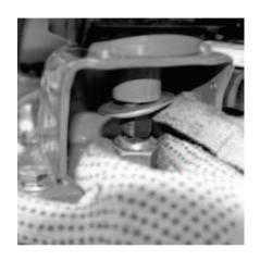
**ШАГ 7.**Закрутить фиксирующую гайку на крепежном валу рукоятки управления.
