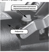
Каждый раз перед началом культивации проверяйте состояние редуктора, вала редуктора, фрез и креплений. При наличии масляных пятен в нижней части редуктора или вале обратитесь в сервисный центр. Если фрезы пришли в негодность, приобретите новые. Помните, что мотоблок поставляется без масла в редукторе.
