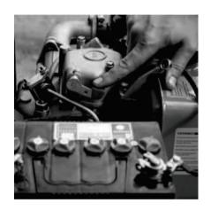
**ШАГ 7.**Нажмите на рычаг декомпрессионного клапана.
