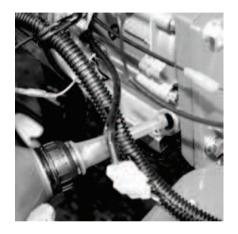
Залейте в картер двигателя дизельное масло для 4-х тактного двигателя SAE5W-30 или SAE10W-40 по уровню на щупе.
