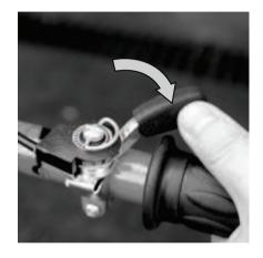
**ШАГ 2.**Установите рычаг **«вкл/выкл»** двигателя в нерабочее положение.
