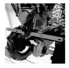
Прикрепить кронштейны крепления защитных кожухов к раме двигателя.
