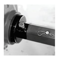
**ШАГ 4.**Установить колесо на выходной вал редуктора при помощи соединительного пальца и шплинта.
