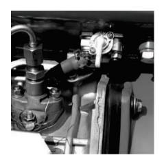
**ШАГ 4.**Переведите рычаг топливного крана в вертикальное положение **«Открыто»**.
