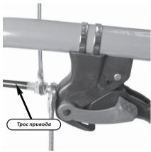
Со временем тросы привода могут растянуться. Для их регулировки необходимо расконтрить гайку и добиться оптимального натяжения тросов. Оптимальной регулировкой троса является начало движения мотоблока при нажатом рычаге сцепления на ½.
