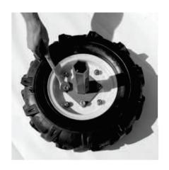
**ШАГ 1.**Закрепить ось колеса к колесному диску с помощью крепежа.
