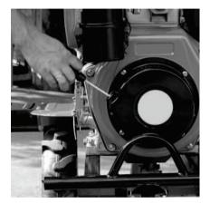
Переведите рычаг топливного крана в горизонтальное (закрытое) положение.
