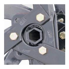
При сборке фрез следите за тем, чтобы при вращении ножи входили в землю заточенной частью. На фланец устанавливается по три ножа.
