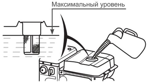
Рис. 7 Максимальный уровень топлива в топливном баке
