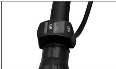
Рис. 14 Выключатель зажигания
