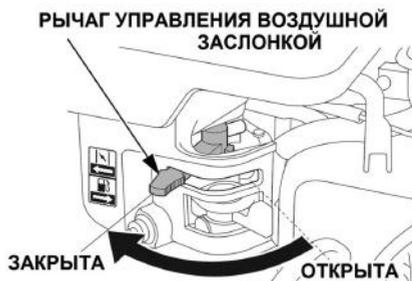
Рис. 12 Рычаг управления воздушной заслонкой
