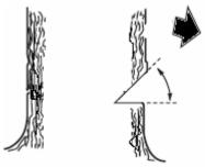
Основной пропил. Основной пропил делается с противоположной стороны дерева . Он должен быть строго горизонтальным. Встаньте с левой стороны
