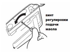
Регулировка масляного насоса.
