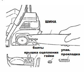
Операцию по установке шины и натяжке цепи , проводите в защитных перчатках, чтобы избежать ранений. Двигатель должен быть заглушен.
