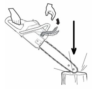
Обслуживание Тормоза Цепи Внимание! Крышку сцепления для проведения обслуживания невозможно снять, если сработал тормоз цепи. Включите тормоз прижав щиток рычага в верхней рукоятке, до щелчка.
