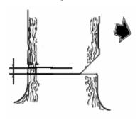
.Закончить основной пропил нужно параллельно линии направляющего пропила так, чтобы расстояние между ними составляло около 1/10 диаметра ствола. Не допиленный участок ствола называется полоса разлома.
