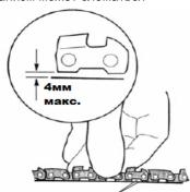
Поворачивая регулировочный винт по часовой стрелке, отрегулируйте натяжение цепи, так чтобы цепь достаточно плотно прижималась к нижнему краю шины и ведущие звенья не выходили целиком из паза шины, но рукой Вы свободно могли провернуть цепь.
