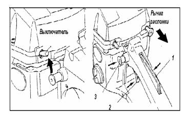
Включите зажигание , нажав тумблер зажигания вверх.
