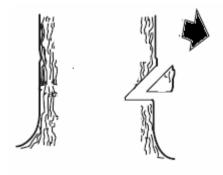
Линия, на которой смыкаются два этих пропила, называется направляющей линией. Эта линия должна быть строго горизонтальной и составлять прямой угол к предполагаемому направлению падения.
