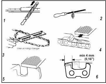
Для заточки в зависимости от типа цепи пользуйтесь специальными принадлежностями – круглым напильником, шаблоном для правильной установки угла,
