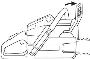
**Запуск:** Тормоз цепи должен быть включен при запуске моторной пилы. Активируйте тормоз, переведя щит отдачи вперед.
