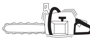
При работе с моторной пилой вибрации возникают вследствие "неравномерного" контакта цепи и распиливаемого дерева.
