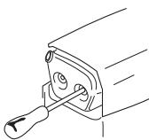
Если глушитель на вашей машине дополнительно оборудован искрогасящим фильтром, его следует регулярно прочищать. Забившийся фильтр может вызвать перегрев двигателя и привести к серьезным повреждениям двигателя.
