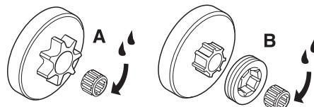
Обе модели имеют встроенный игольчатый подшипник на приводном валу, который следует регулярно смазывать (раз в неделю).
