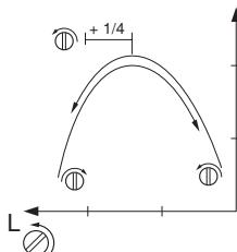
Искайте максимальные обороты холостого хода поворотом винта **L** медленно по часовой стрелке или соответственно против часовой стрелки. Когда будут установлены максимальные обороты холостого хода, поверните винт **L** на 1/4 оборота против часовой стрелки.
