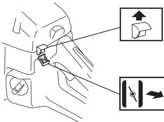
Если машина оборудована декомпрессионным клапаном (A): Его необходимо нажать, чтобы уменьшить давление в цилиндре и облегчить запуск машины. При запуске машины всегда пользуйтесь декомпрессионным клапаном. После запуска машины он автоматически вернется в свое первоначальное положение.
