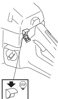
Двигатель останавливается путем выключения зажигания.
