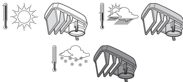
Воздушный фильтр после эксплуатации в течение некоторого времени невозможно полностью вычистить. Поэтому его нужно периодически менять на новый. Поврежденный воздушный фильтр необходимо заменить.
