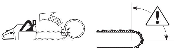
Резка нижней кромкой полотна, т.е. от поверхности объекта к нижнему краю известна как пиление с нажимом. В этом случае моторная пила сама наезжает на дерево и передний край моторной пилы соответствует естественному положению при резке. Пиление с нажимом обеспечивает лучший контроль над моторной пилой и расположением области отдачи.
