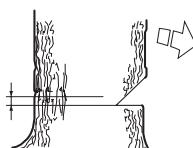
Вставьте зубчатый упор (если установлен) сзади надреза. Работайте на полном газу и вводите пильное полотно в ствол дерева постепенно, плавным движением. Следите за тем, чтобы дерево не начало перемещаться в направлении,
