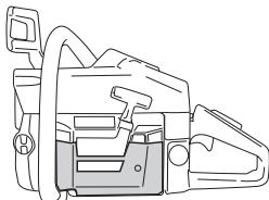
**ВНИМАНИЕ!** Если для повышения рабочей температуры двигателя применяются специальные приспособления для работы в зимних условиях, необходимо заново отрегулировать все характеристики машины, установленные для работы в нормальных условиях. В противном случае может произойти перегрев двигателя, что приведет к его серьезным повреждениям.
