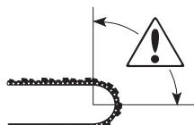
**ПРЕДУПРЕЖДЕНИЕ!** Мы рекомендуем не приступать к повалке деревьев с диаметром, большим длины режущего полотна, без специальной подготовки!
