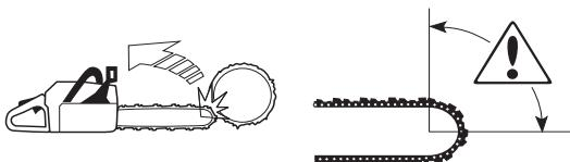
Отдача всегда происходит в плоскости резания пилы. Обычно при отдаче моторную пилу отбрасывает назад и вверх в направлении рабочего. Тем не менее моторная пила в момент отдачи может двигаться в различных направлениях в зависимости от метода резки, который применялся в момент касания зоны отдачи полотна и объекта.
