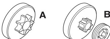
Следует регулярно проверять степень износа звездочки привода. Заменять при сильном износе. При замене цепи следует одновременно заменять и звездочку привода.
