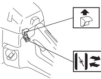
Пользуйтесь той же последовательностью как для холодного двигателя, но без открытия заслонки. Пусковое положение дроссельной заслонки устанавливается переводом воздушной заслонки в закрытое положение и последующим возвратом в открытое.
