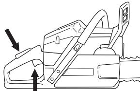
После того, как двигатель сделает первую вспышку, верните сразу рычаг воздушной заслонки в первоначальное положение, открывая воздушную заслонку, и повторите запуск. Когда двигатель запустится, дайте полный газ и отпустите рычаг дроссельной заслонки и блокировка пускового положения дроссельной заслонки отключится.
