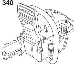
Цепь считается натянутой правильно, если она свободно проворачивается рукой. После этого, удерживая носок пильного полотна в верхнем положении, затяните гайки крепления пильного полотна универсальным ключом.
