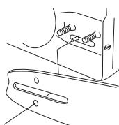
Для этого поверните винт механизма регулировки цепи по часовой стрелке. Цепь следует натягивать до тех пор, пока она не будет плотно прилегать к нижней стороне пильного полотна.
