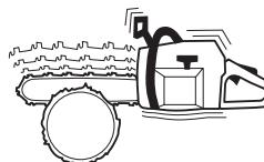
Пиление твердых пород дерева (большинство широколиственных деревьев) вызывает более сильную вибрацию, чем пиление мягких пород (большинство хвойных деревьев). Работа с затупившейся или неисправной цепью (неправильная или плохая заточка) приводит к повышению уровня вибрации. См. раздел Режущее оборудование.
