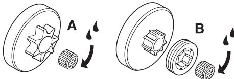
Обе модели имеют встроенный игольчатый подшипник на приводном валу, который следует регулярно смазывать (раз в неделю). **ВНИМАНИЕ!** Пользуйтесь смазкой для подшипников хорошего качества или моторным маслом.
