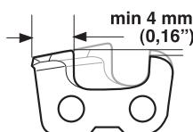
При стачивании режущих зубьев до длины 4 мм цепь изношена и ее следует заменить.
