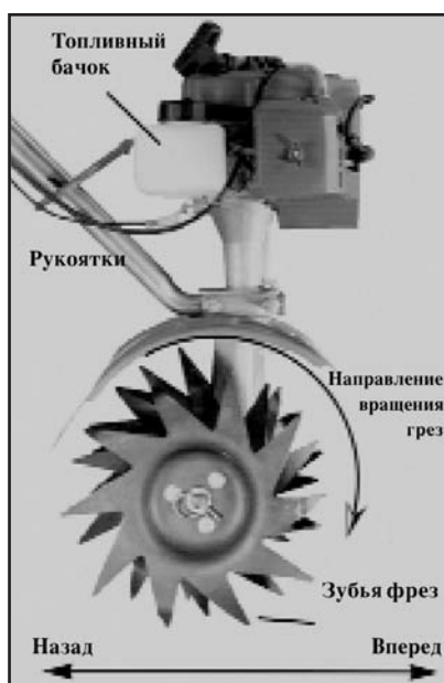
Положение культивирования: Зубья фрез смотрят против вращения, т.е. назад, к оператору.
