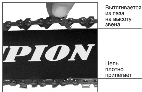
Рис. 6 Регулировка натяжения цепи
